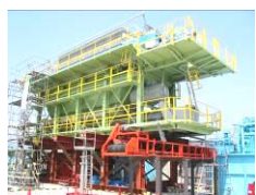
脱水固化(高強度化が必要な場合は、マグネシウム固化剤を添加)
