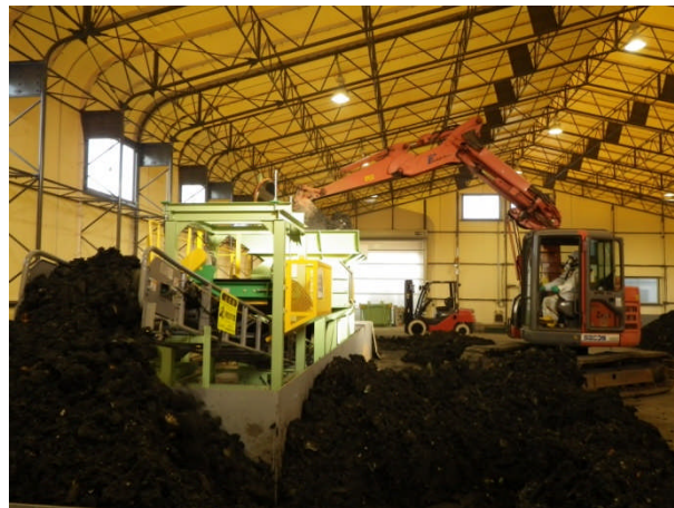
写真 5 二軸破砕機による粒度調整
