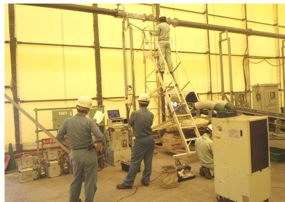
写真 8 排ガスサンプリング（横浜市立会）
