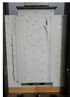
写真9 破断状況 (せん断試験)
