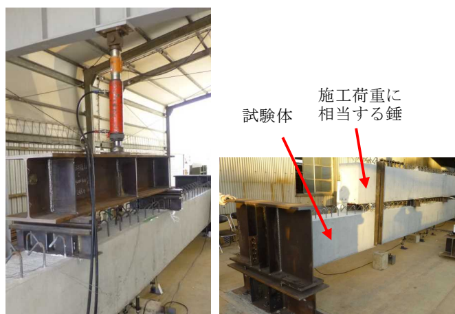
(a) 油圧ジャッキによる加力 (b) 錘によるクリープ測定 写真5 PCa小梁実大実験
