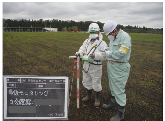
写真8 監督員による事後の空間線量の確認
