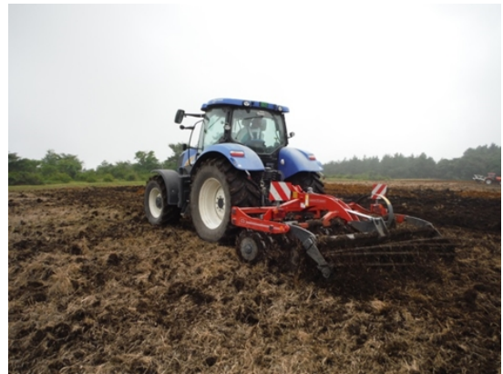
写真2 ディスクハローによる表層攪拌
