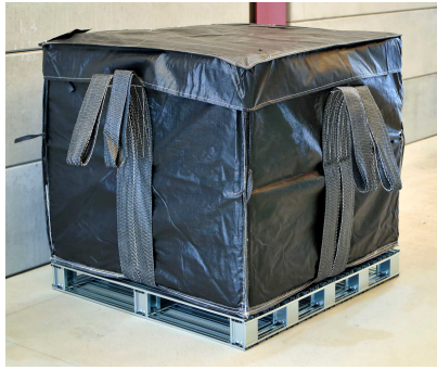
写真8 固型化物を収納した角型フレキシブルコンテナ
