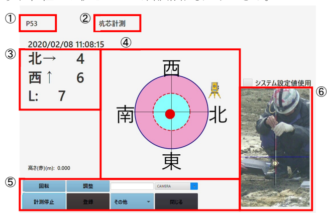
図1 杭芯計測時のタブレット画面
