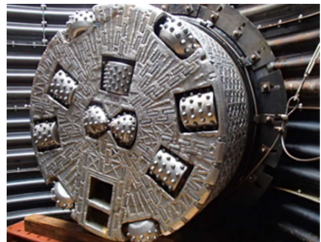
写真13 掘進機到達状況(上流側到達立坑)
