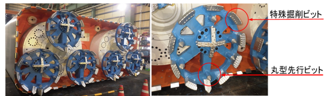
写真2 推進機全景と楕円形カッター
