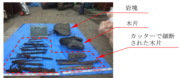
写真7 チャンパー内で確認された障害物
