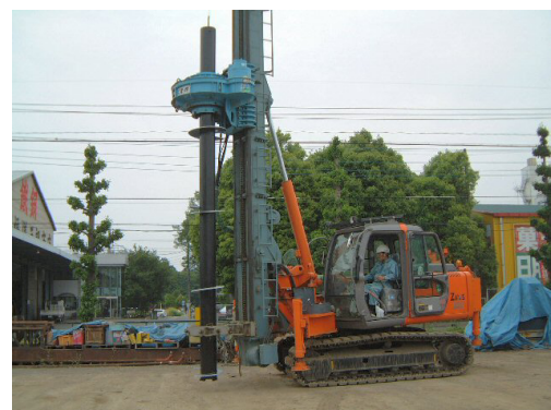
写真 2 中空オーガ使用状況例
