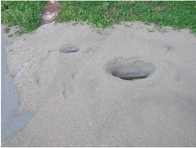
写真 8 側道で確認された噴砂 (写真 7 の噴砂の一つを接写)
