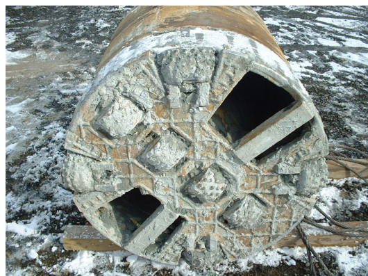
写真 20 到達後の泥水式 K-1 推進機
