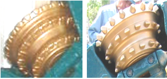
写真4 左:チップインサートと右:チゼルタイプ
