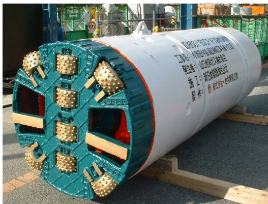
写真 18 φ800 mm泥水式K-1 推進機
