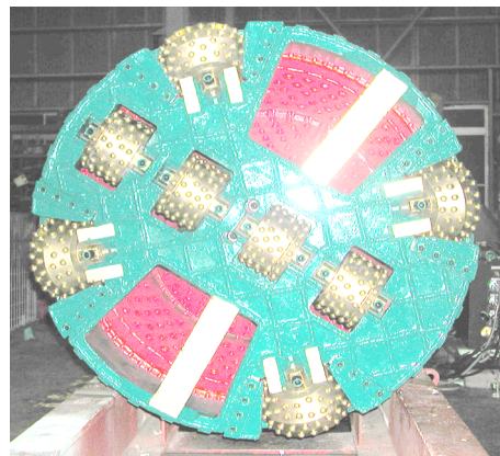
写真15 φ800mm泥水式K-1機面盤
