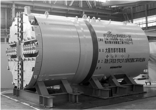
写真1 泥水式シールド機
