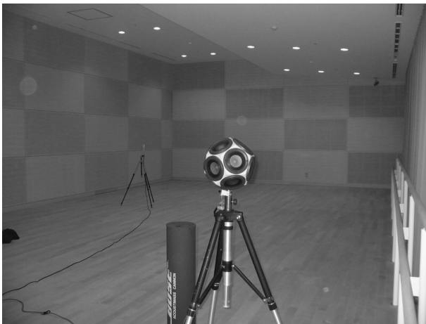
写真4 スタジオの音響測定状況
