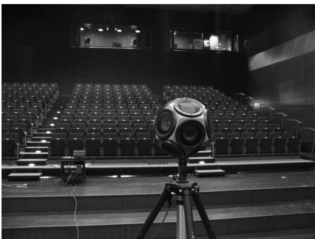
写真5 ホールの音響測定状況
