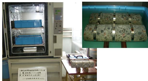
写真3 コア供試体の養生、および線膨張係数測定状況
