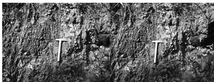
硬質なレンズ状の砂岩ブロック、周辺の泥質岩は強風化
