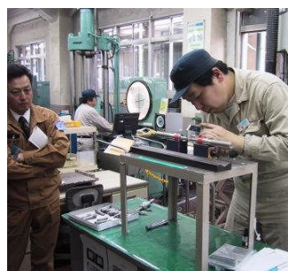
写真6 溶着金属引張試験
