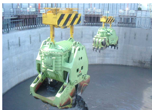
写真 4 電動油圧グラブ（容量 3m 3 、重量 15t）
