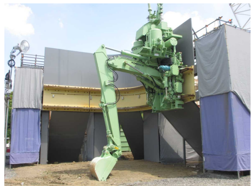
写真6 作動確認試験中の新型水中掘削機
