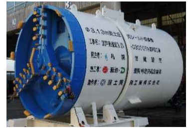
写真 4 シールド機全景
