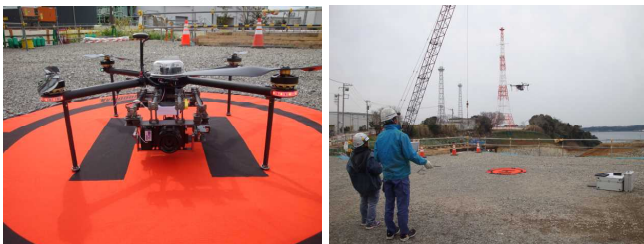
(a) 使用機体 (b) 実施状況 写真1 UAV測量の実施状況
