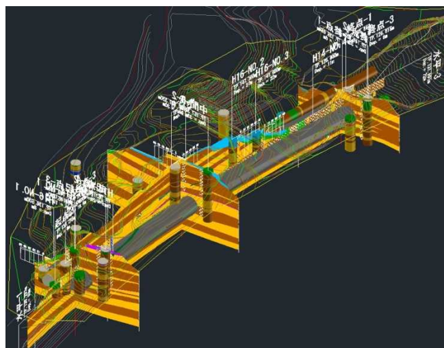
図4 入力データの3次元表示例（八幡トンネル）
