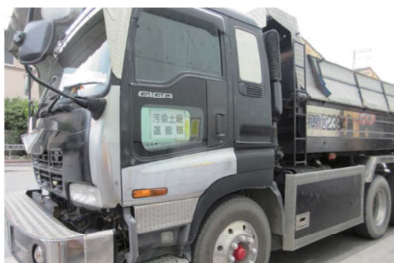
写真2 汚染土壌運搬車のステッカーによる明示
