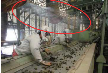
写真 18 ミスト噴霧機および送風機
