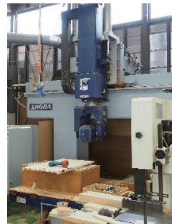
写真 37 5 軸 NC 切削機
