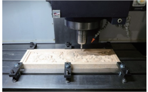
写真19 NC切削状況
