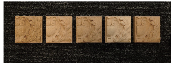
写真21 複数樹種での加工性確認
