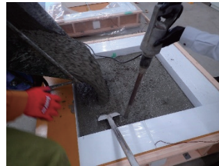
写真1 打ち込み状況
