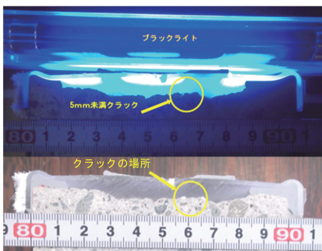
写真5 マイクロクラック測定状況
