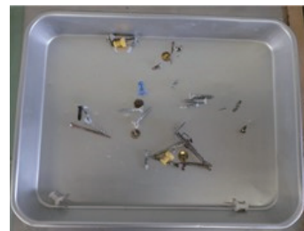
写真3 選別回収した試料Aの回収石膏粉（左）・異物（中央）・鉄類（右）
