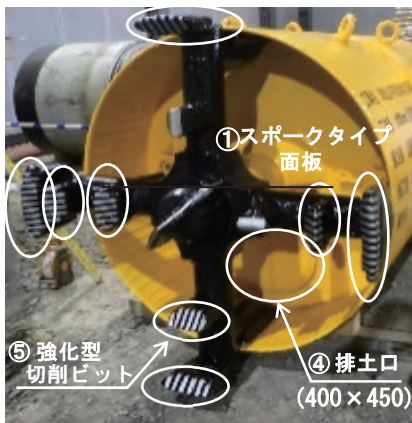
写真 3 取込型推進機（前面）
