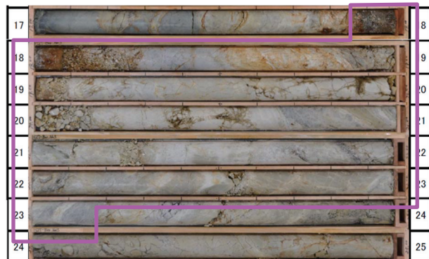
写真 2 ボーリングコア (H27-Bor. No. 3、深度 17~25m)
