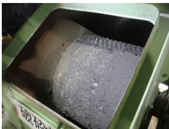
写真3 破砕機への処理対象物付着状況
