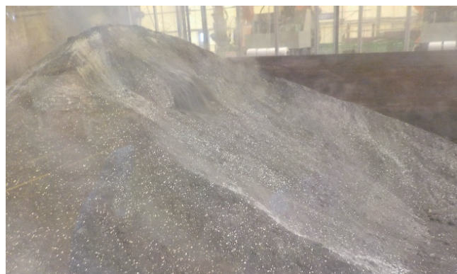
写真11 生石灰添加・混合直後の処理対象物
