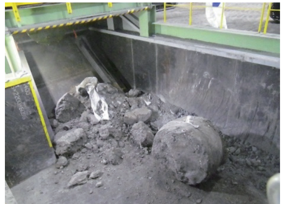
写真1 強く硬化した処理対象物（硬化灰）
