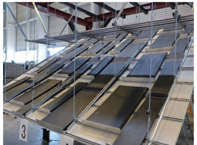
写真7 試験体全景 (おもり載荷状況)
