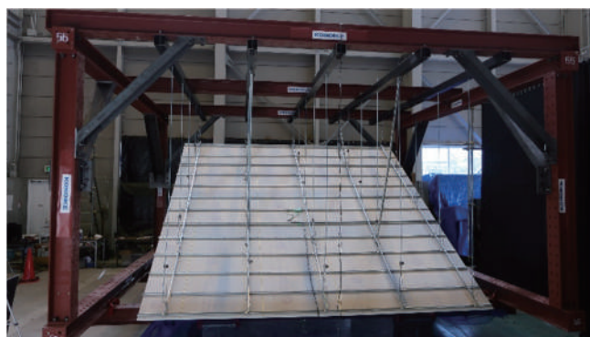
写真 11 加振後の状況（帯塗・拡頭ワッシャータイプ）
