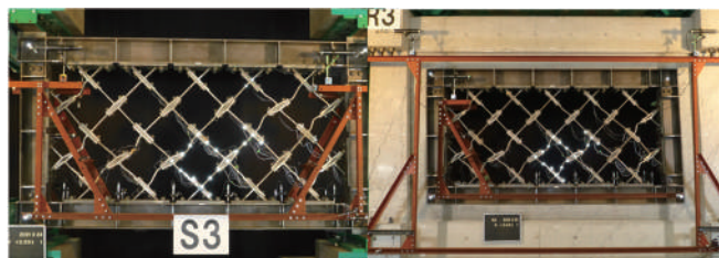
(1) 試験体 S3 (2) 試験体 R3 写真 4 最終破壊状況 (R=1/50rad. 時)
