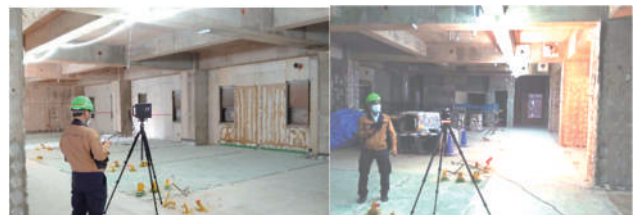
写真 2 3D レーザースキャナ・Matterport の計測状況
