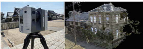
図4 点群データ取得のイメージ
