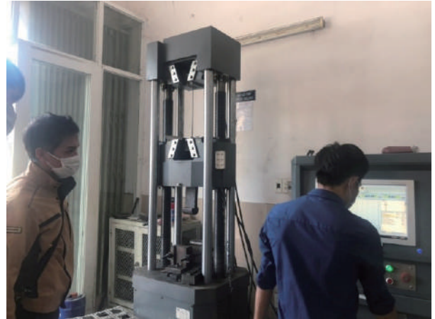
写真3 鉄筋曲げ試験確認状況
