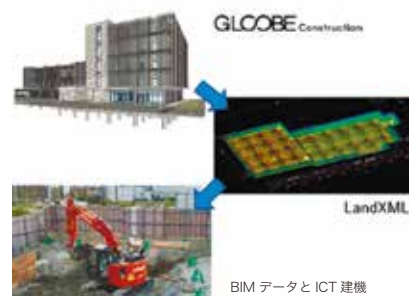
BIMデータとICT建機
