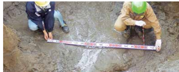
フィールド試験による改良土の出来形確認例(実測半径1.55m)
