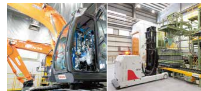
遠隔操作重機
